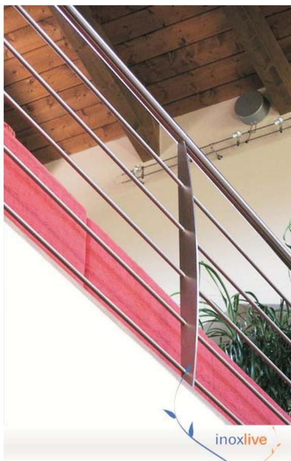
**FLAT** è il modello che nasce dall'idea di semplificazione del parapetto, il montante è stato sviluppato per ottenere il minore ingombro visivo ed ottenere un parapetto dalla forma decisamente minimalista ma di grande robustezza. Il montante è ricavato da lamiera in acciaio inox sp.8mm, sagomato al laser e può essere sagomato in diverse forme su indicazioni del cliente.
